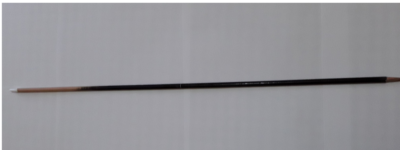
Figura 1: Asta in legno Douglas fir. 30" 85/90# rastremata da 23/64" a 5/16"
